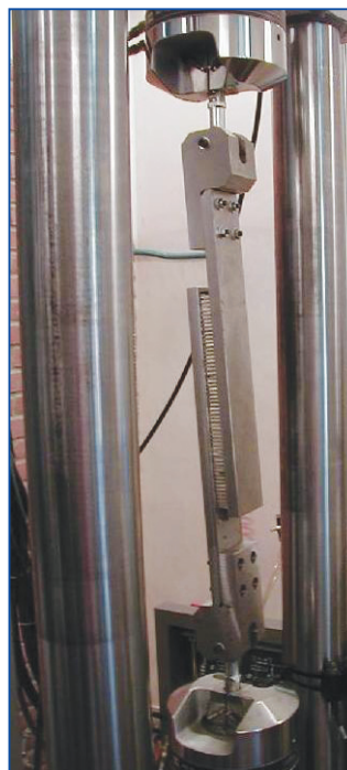
[Fig. 3] - Prova di taglio su core in honeycomb in lega di alluminio / Shear test on aluminium honeycomb core
