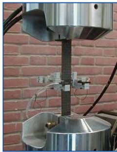
[Fig. 2] - Prova di trazione con estensometro biassiale su laminato carbonio/epossidica Tensile test with bi-axial extensometer on a carbon/ epoxy laminate
